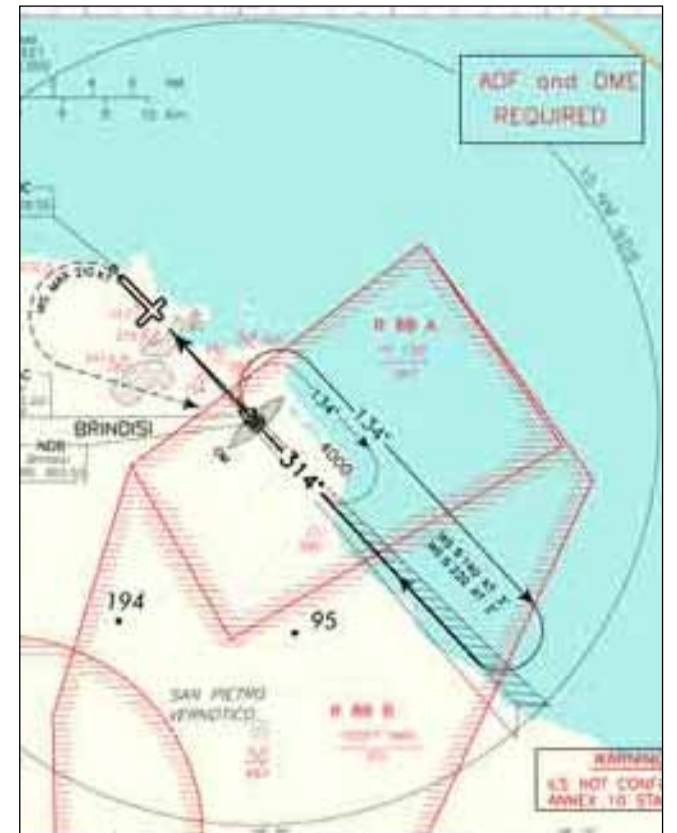
Procedura di atterraggio strumentale di precisione
