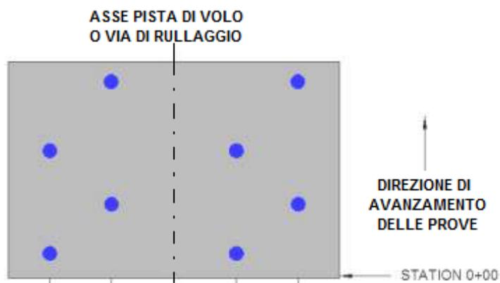
Figura B-1 - Posizionamento indicativo dei punti di misura delle deflessioni nelle pavimentazioni flessibili e semi-rigide di piste di volo e vie di rullaggio
