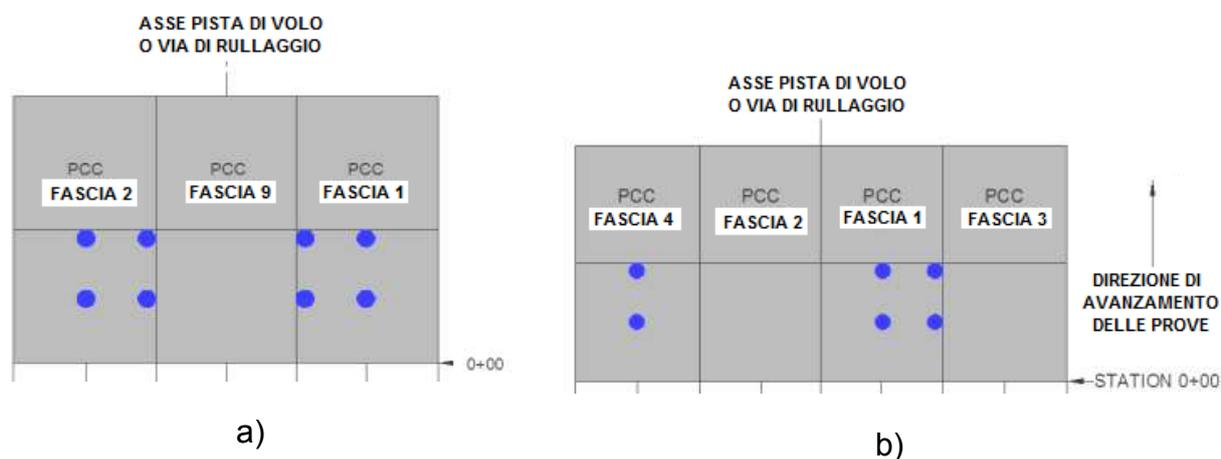
Figura B-2 – Posizionamento indicativo dei punti di misura delle deflessioni nelle pavimentazioni rigide di piste di volo e vie di rullaggio: a) con asse non coincidente a) e coincidente b) con giunti longitudinali
