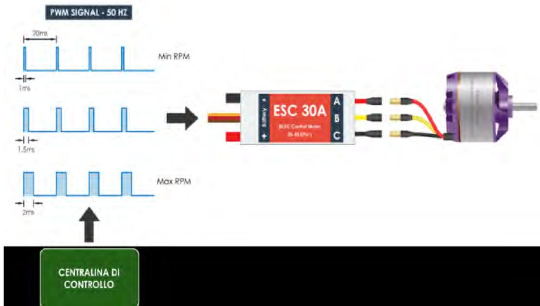
La centralina di controllo, in base ai sensori di bordo ed ai comandi del pilota, regola la velocità dei motori attraverso l'invio di un segnale digitale all'ESC che ha un'ampiezza temporale minima di 1 millisecondo (la potenza è prossima allo 0%) ed una massima (potenza al 100%) di 2 millisecondi.
