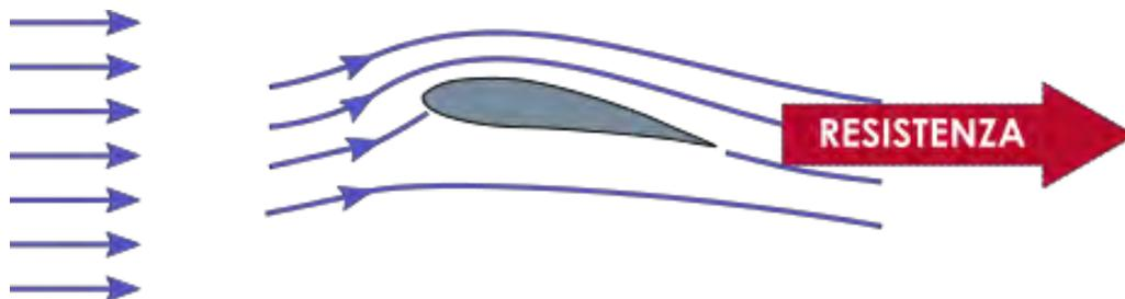
La resistenza di un profilo è composta dalla resistenza di attrito (tra aria e pareti esterne), dalla resistenza di forma (dovuta al comportamento aerodinamico) e dalla resistenza indotta, generata dal flusso
