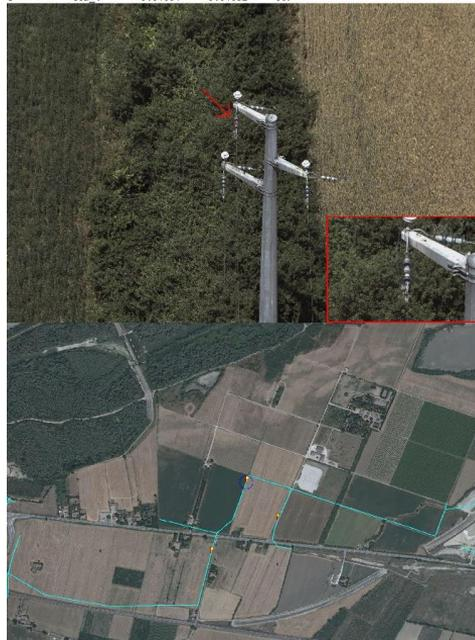
CABINE, Gestione MT, Dispositivi per la protezione da sovratensioni assenti o con anomalie
