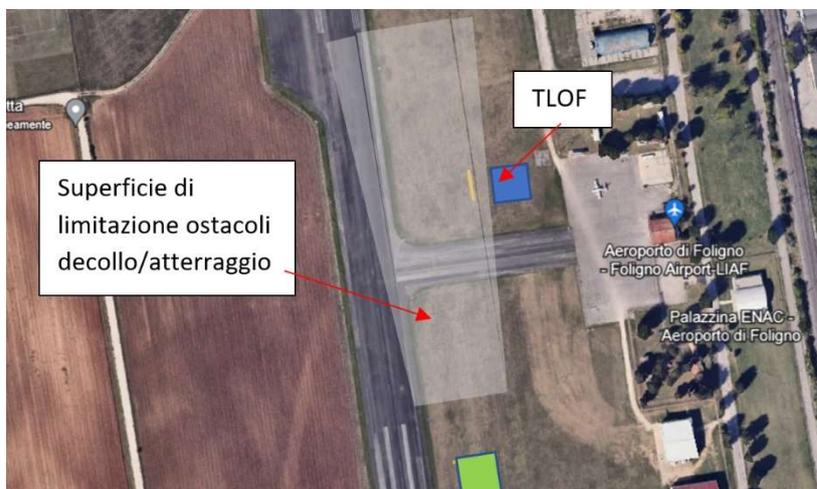
L'esatta collocazione della FATO e della TLOF di progetto sarà definita in accordo alla normativa Enac "Regolamento Costruzione ed esercizio Aeroporti" e Regolamento Costruzione ed esercizio Eliporti" che costituisce il riferimento applicabile in ambito infrastrutturale in ordine al rispetto delle superfici di limitazioni ostacoli applicabili alla pista di volo RWY 35-17 GLD
