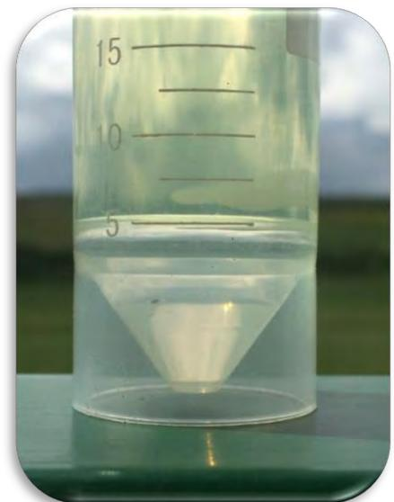
La capacità di rimanere in soluzione diminuisce drasticamente con la diminuzione della temperatura, facendo quindi avvenire la separazione di fase, ossia la separazione in due fasi distinte:
