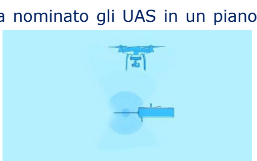
Figura 6.27 – corretto puntamento antenne del radiocomando:
