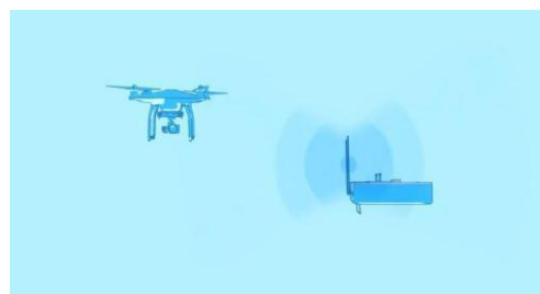
Figura 6.26 – corretto puntamento antenne del radiocomando:
