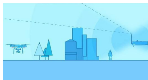
Figura 6.25 – errato puntamento antenne del radiocomando:
