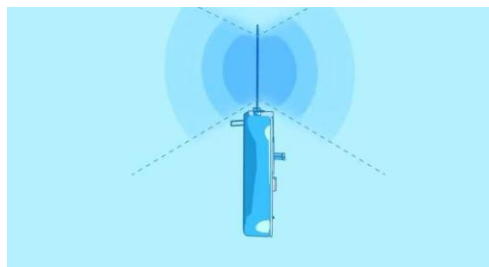
Figura 6.24 – Lobi di emissione antenna trasmittente
