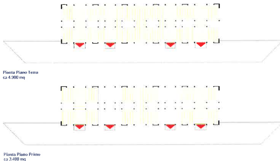
Figura 3: superfici controsoffitto piano terra e piano primo
