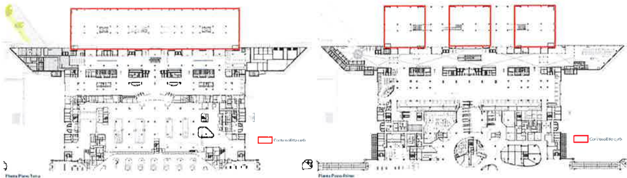
Figura 2: estensione controsoffitto piano terra e piano primo
