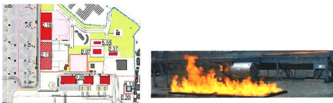
Figura 15: Stralcio della planimetria Master Plan ed esempio di vasche per simulazione incendio
