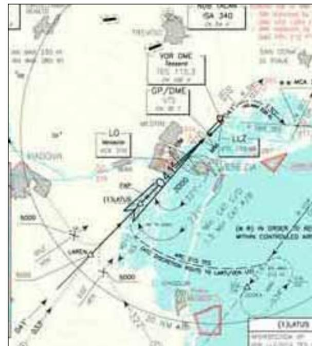
Procedura di atterraggio strumentale di precisione
