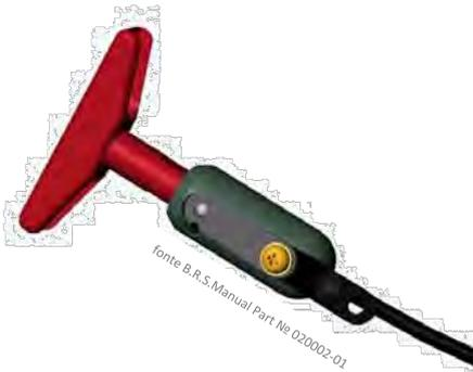
Il sistema di attivazione, che collega la maniglia al razzo, è una "fune" metallica che funziona in maniera simile a quella dei freni della bicicletta. Questo significa che si potrebbe involontariamente attivare il sistema anche dopo l'incidente semplicemente spostando i rottami del velivolo.
