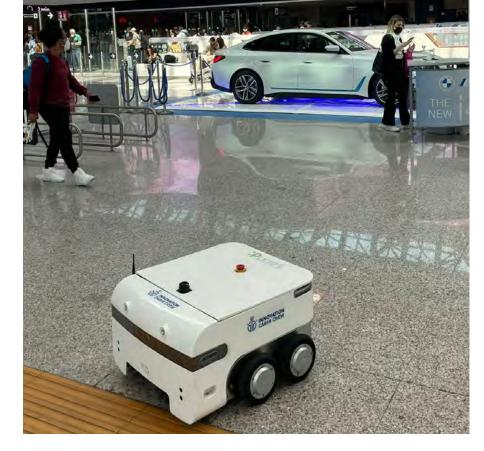
accoppiata con due robot mobili autonomi che, grazie ad algoritmi di Al, riescono a navigare all'interno di spazi complessi effettuando operazioni di cleaning automatico;
