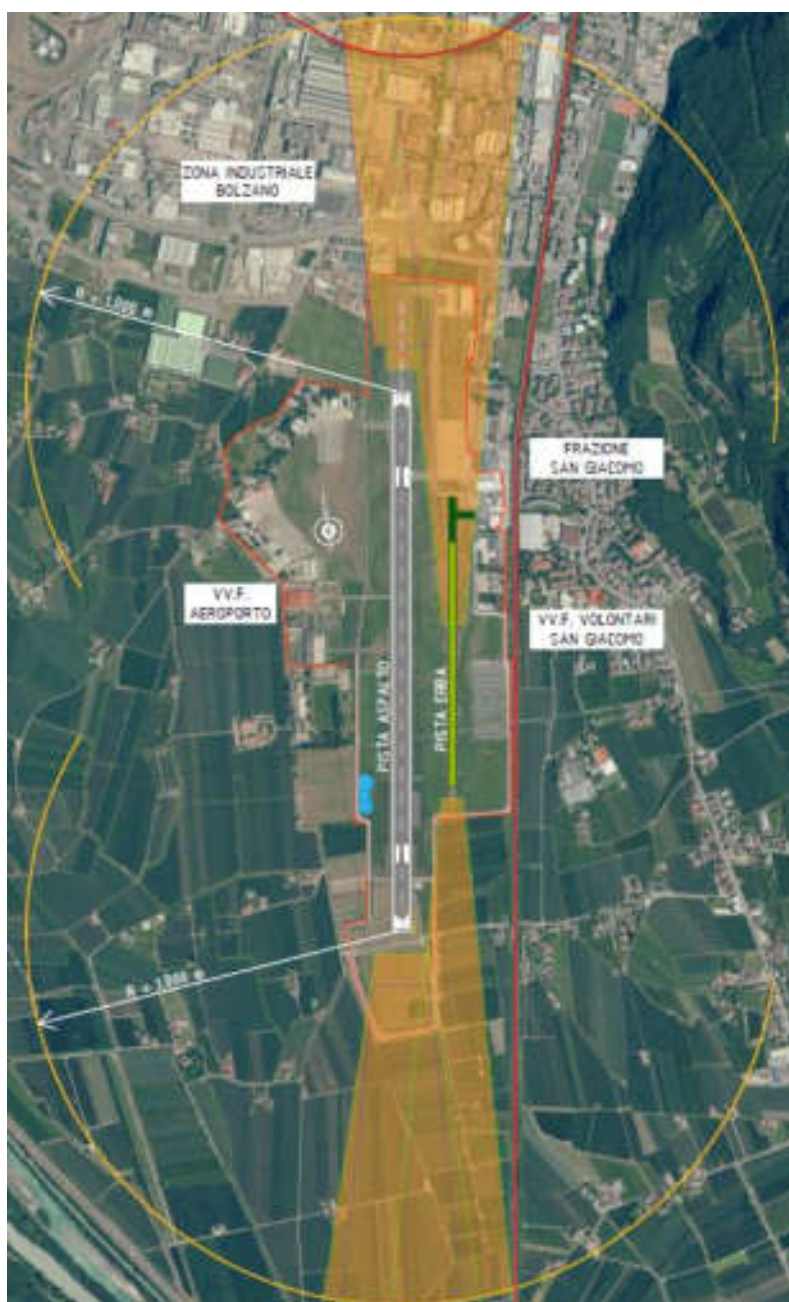
Figura 7: sovrapposizione delle approach e take-off climb surfaces delle piste di volo fino ad una distanza di 1.000 m dalle rispettive soglie.
