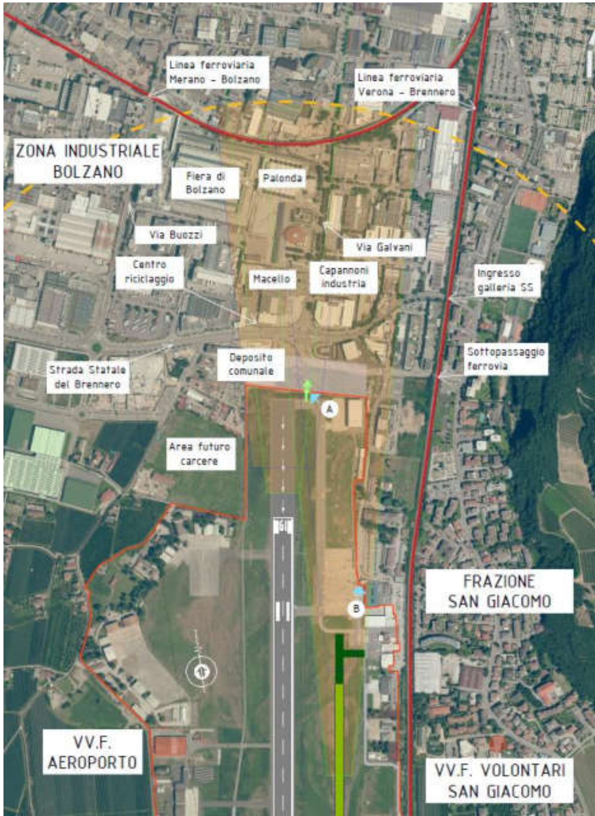
Figura 9: dettaglio della approach and departure area a nord delle piste fino a 1.000 m dal fine pista (vedasi linea tratteggiata gialla).
